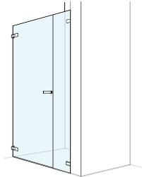
Pendeltüre Wandanschlag mit Seitenwand in Flucht mit Seitenwand
