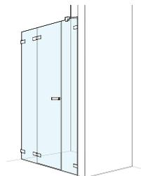
Pendeltüre mit Festelement und Seitenwand in Flucht mit Seitenwand
