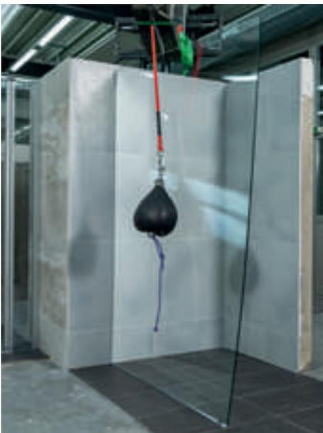
Sicherheit geht vor: Der Pendelschlagtest ist die unbestechliche Sicherheitsprüfung für *Koralle gluetechnik*. Die mit dieser Klebetechnik befestigte, freistehende Seitenwand aus Glas hält der Wucht des Pendelschlages sicher stand.
