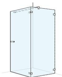
Pendeltüre mit Seitenwand in Flucht Bandung an Seitenwand
