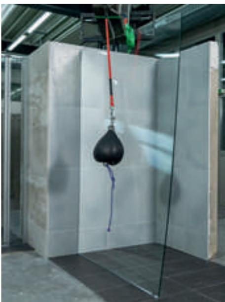
Sicurezza al primo posto: il test del pendolo dimostra in modo inconfutabile la tenuta di *Koralle gluetech*. La parete laterale libera in vetro fissata con questa tecnica resiste perfettamente all'impatto del pendolo.
