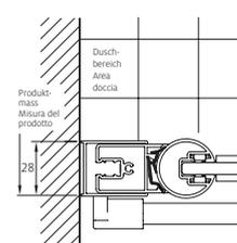
Mit oder ohne Schwallprofil bei Montage wählbar.
