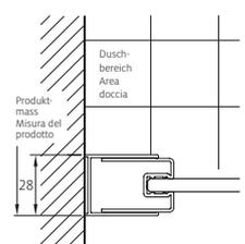
Mit oder ohne Schwallprofil bei Montage wählbar.
