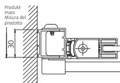
Mit oder ohne Schwallprofil bei Montage wählbar.
