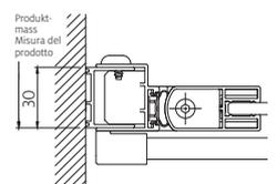
Mit oder ohne Schwallprofil bei Montage wählbar.
