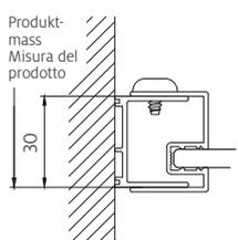
Mit oder ohne Schwallprofil bei Montage wählbar.
