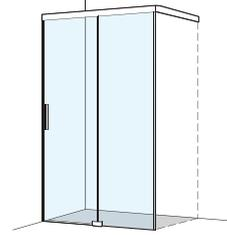
Option: U-Kombination (mit zwei Seitenwänden)
