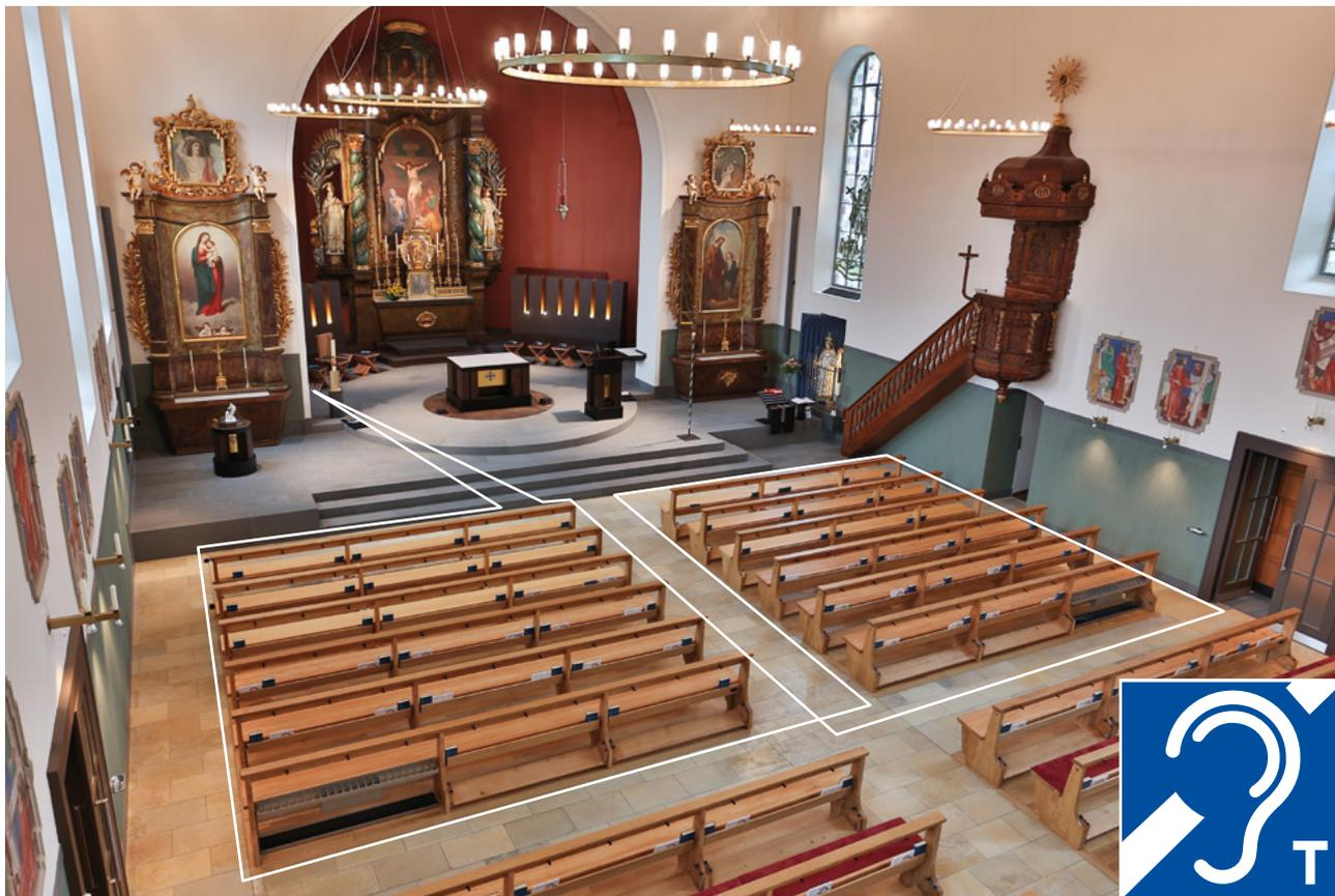
**Kirchen gehören zu den öffentlichen Gebäuden, für die der Bund induktive Höranlagen nach Norm SIA 500 vorschreibt.** Hörgeräte empfangen das Audiosignal direkt über die im Boden verlegten Schleifen. Die erforderliche Signalstärke und der Frequenzbereich werden in der Norm EN 60118 Part. 2006 vorgeschrieben.
