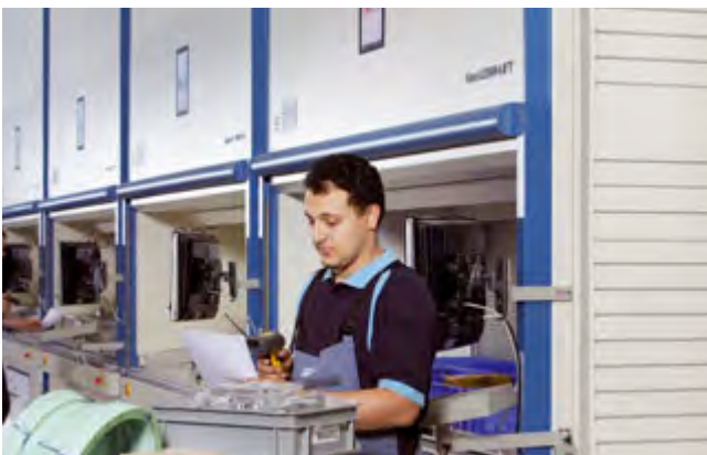
Alle Vorgänge werden per Barcode erfasst und an den modernen Touchscreen-Bildschirmen direkt am Lean-Lift® verbucht
