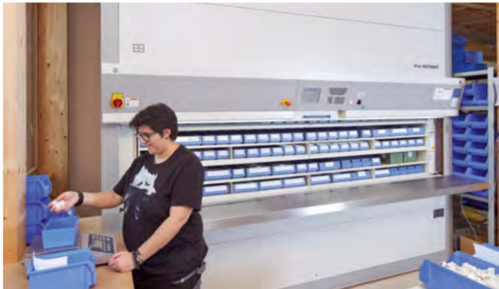
Das Schüttgut wird direkt am Lift per Zählwaage gezählt und anschliessend in der Montage bereitgestellt
