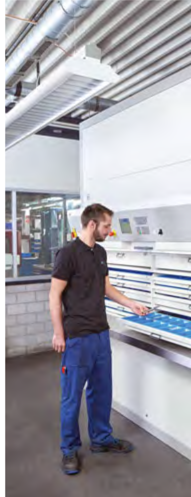
Sämtliche Werkzeuge für den gesamten Maschinenpark werden in einem Rotomat® Lagerlift organisiert und zentral verwaltet
