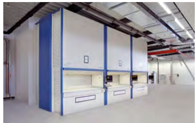
Durch die kompakte und höhenoptimierte Lagerung der unterschiedlich grossen Artikel wird eine optimale Raumausnutzung erreicht
