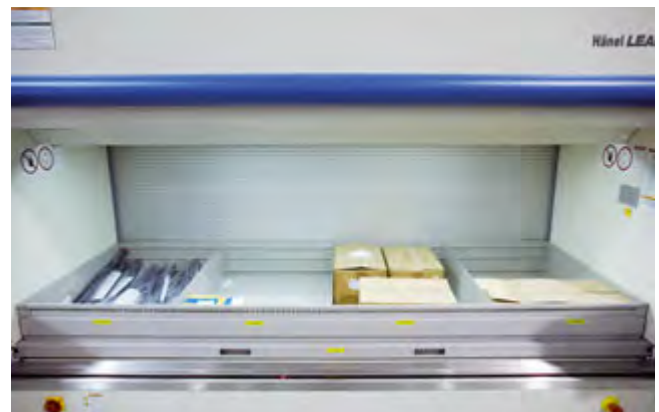
Um hohe Transportgeschwindigkeiten realisieren zu können, werden die Tableaux zum Schutz des Lagerguts mit montierbaren Seitenwänden versehen
