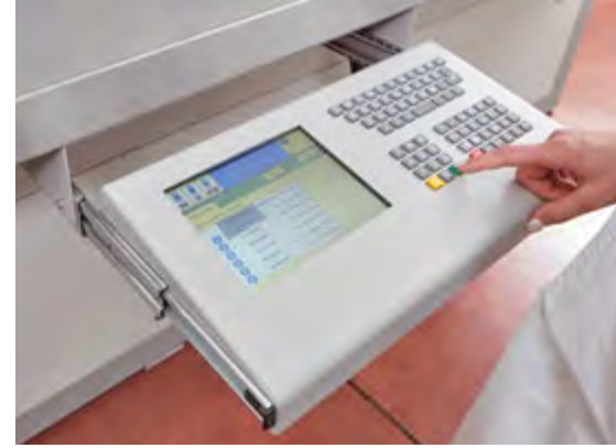
Die Hänel Zentralsteuerung MP 100 D verwaltet die Lagerplätze von allen drei Liften
