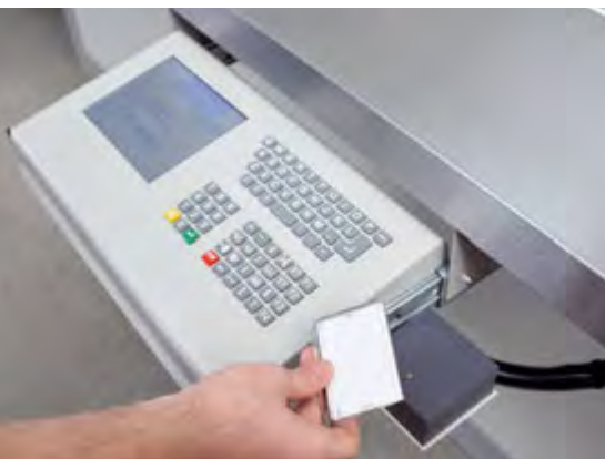
Die unkomplizierte Autorisierung erfolgt direkt am Terminal per RFID-Karte
