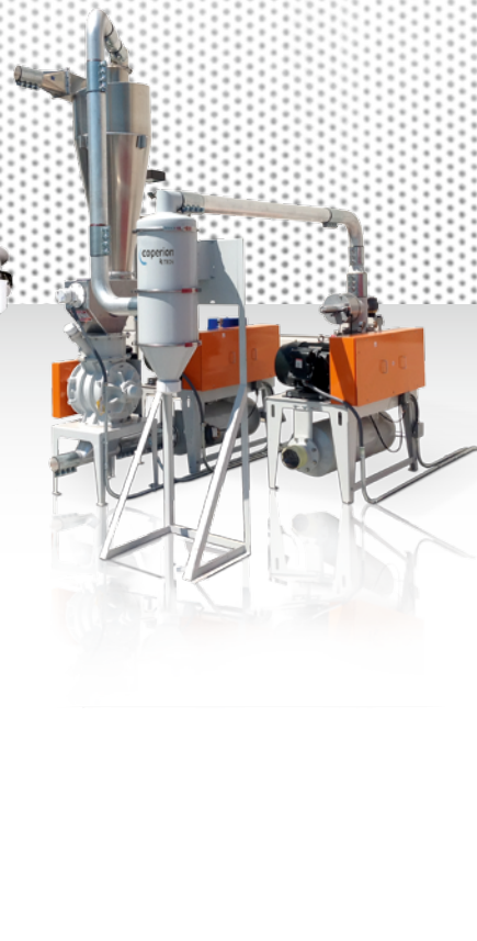
ENTLADEN VON LKWS UND WAGGONS Differenzdruckgesteuerte Entladesysteme für LKWs und Bahnwaggons verfügen über ein Gebläsesystem und SPS zur Überwachung des Betriebs.
