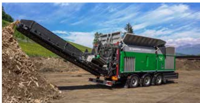
Broyeur à 2 arbres à vitesse lente (pour le bois et les déchets verts)
