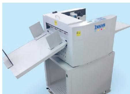
**Swift Pro** besticht durch ihre solide Ausstattung die sich auf das Wesentliche beschränkt. Sie bietet eine Rill- und Perforierfunktion quer mit der Möglichkeit Werkzeuge in Laufrichtung zu montieren. Somit sind Rillen, Perforieren, Kiss Cut und Schneiden bis max. Format 330 x 650 mm möglich. Die Bedienung ist einfach: über ein LC-Display und Softkeys gelangt man schnell zu den gewünschten Menüs.
