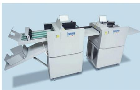
**Lightning Fold Pro**, ein Alleskönner. Schneiden, Rillen, Perforieren und Falzen! 7 Falzarten, bis Format 330 x 650 mm. Die dem Falzmodul vorangestellte Rill- und Perforiermaschine kann auch als Solomaschine betrieben werden. Partiiell abgesetzte Längs-Perforationen, verschieden breite Rillungen oder Kiss-Cuts sind problemlos herzustellen.
