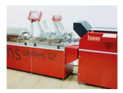
Das neue Kuvertier- und Mailingsystem MS Series 12 entspricht den veränderten Marktanforderungen zur Herstellung personalisierter Mailings im mittleren Auflagenbereich. Hohe Produktivität, grosses Format- und Materialspektrum und Flexibilität in der Endverarbeitung. Mit seinem modularem Aufbau ist das System flexibel zu konfigurieren. 2 bis 10 Einlagestationen, Eingangskanal mit Falzoption, Formate für Couverts DL, C5, C4 (max 229 x 324 mm).
