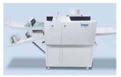
**Galaxy Fold** kann Rillen, quer Perforieren und anschliessend Falzen. 7 Falztypen sind am Touch Screen abrufbar (siehe Skizze), einfache Einstellung für Falzrollenabstand. Rilltiefe- und Neigung einstellbar, Einschubwerkzeuge für den einfachen Austausch. Saug-anleger bis Format 330 x 650/900 mm - und das alles bis 5'400 Bogen in der Stunde.
