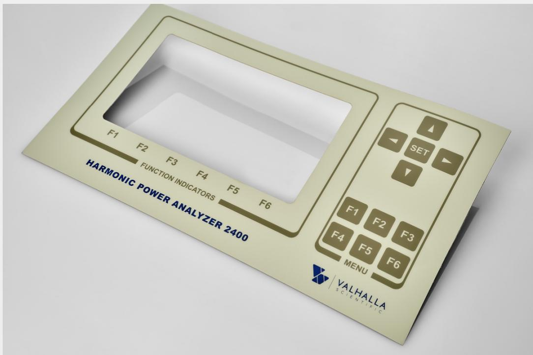
Transparente Polyesterfolien werden rückseitig im Siebdruck- oder Digitaldruckverfahren bedruckt. Durch selektive, ungedruckte Bereiche lassen sich somit auch transparente Fenster realisieren. Zum Beispiel für wechselbare Einschub- Beschriftungsstreifen oder die als Anzeigenfenster verwendet werden können. Rückseitig wird ein doppelseitiger Kleber angebracht.
