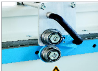
Rollenschiere für Stahl-Blechdicken bis 0.8 mm.
