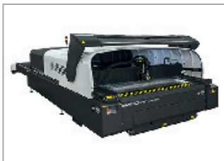
Palettenwechsler für kurze Rüstzeiten mit 2 Schneidtischen.
