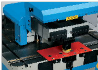
Halter für Stanzwerkzeug Stanzen mit Trumpf-Werkzeugsystem bis D=50 mm (rund, vierkant, Formlöcher).
