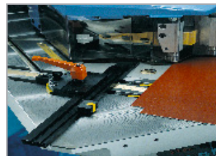
Präzisionspositioniersystem Anschläge mit Passstiften in 15°-Schritten verstellbar sowie Kippanschläge für die doppelten T-Nuten im Tisch.
