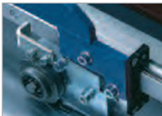
Rollenschiere zum Quertrennen von Hand vor dem Profilieren.
