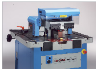
Einheit zum Ausschneiden von Rechtecken für Bleche bis 4 mm und Rechtecke von 25 x 100 mm.
