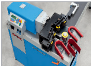
4-Punkt-Biegewerkzeug für Rund-Flach- oder 4-Kt.-Material und dickwandige Rohre bis 180°. Max. 100 x 20 mm oder Ø 50 mm.
