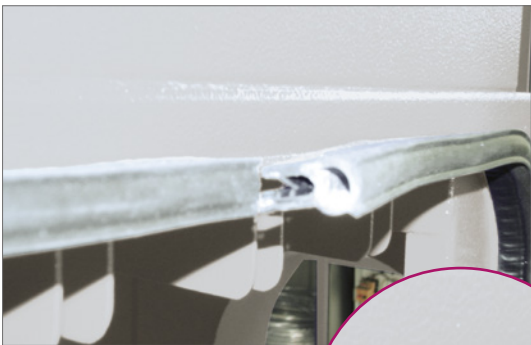
Abb.: Alte Dichtung entfernen
