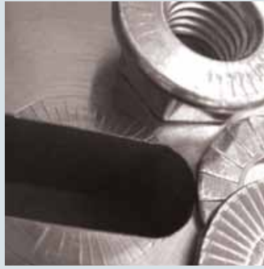
Eine Flanschmutter in Kombination mit Nord-Lock Keilsicherungscheiben (sp) verbessert die Flächenpressung bei Langloch-Applikationen
