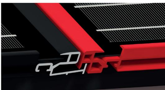
Das zweite Modul gleitet nun in das rechte Profil des ersten Moduls und in das auf der Lattung montierte Basisprofil, ähnlich wie beim Verlegen von Dachziegeln. Die weiteren Module der ersten Reihe werden genau gleich montiert. In der zweiten Reihe wird wieder links begonnen. Nacheinander werden alle Module eingesetzt.
