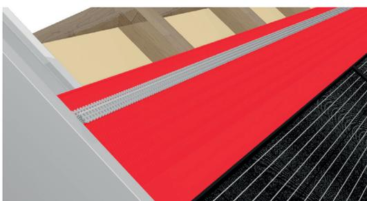
Sind alle Module, wird das obere Abschlussblech mit dem oberen Lochblech montiert...
