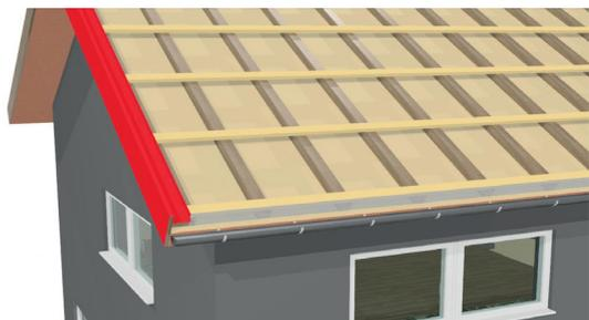
Nach dem Verlegen der wasserfesten Unterspannbahn wird die Konterlattung auf den Dachsparren befestigt. Anschliessend erfolgt die Verlegung der Querlattung.
